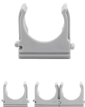
La grampa cumple la función de sostener el tubo. El material plástico utilizado es de gran resistencia mecánica, soporta firmemente el tubo y no pierde la forma con el uso. Tiene una guía para facilitar el registro en el momento de ajustarla a la superficie. Las grampas se pueden acoplar en caso de instalar varios tubos en línea.
