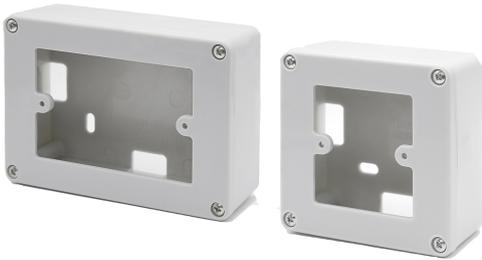
Se presentan en dos tamaños rectangular (B03) o mignón (B01). El material plástico ofrece rigidez al ensamblado y es resistente a los impactos accidentales. Dispone de troquel para cable canal en sus 4 lados aunque también pueden ser conectadas con caños de hasta Ø25.
